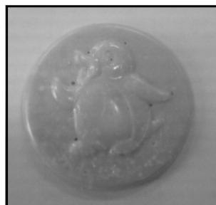
写真11 硬化して完成した離型枠（中段）
