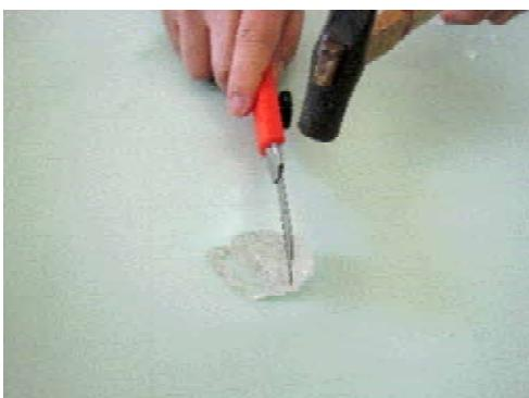
第1面と第2面を割った後は、カッターを用いて面を割り出していく。
